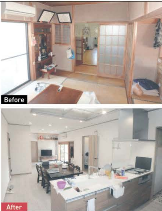
中廊下で分断された居間と食堂・台所を、梁を入れ替え柱と間仕切戸を取り除き、広くて使い勝手の良いスタイリッシュなLDKを実現
