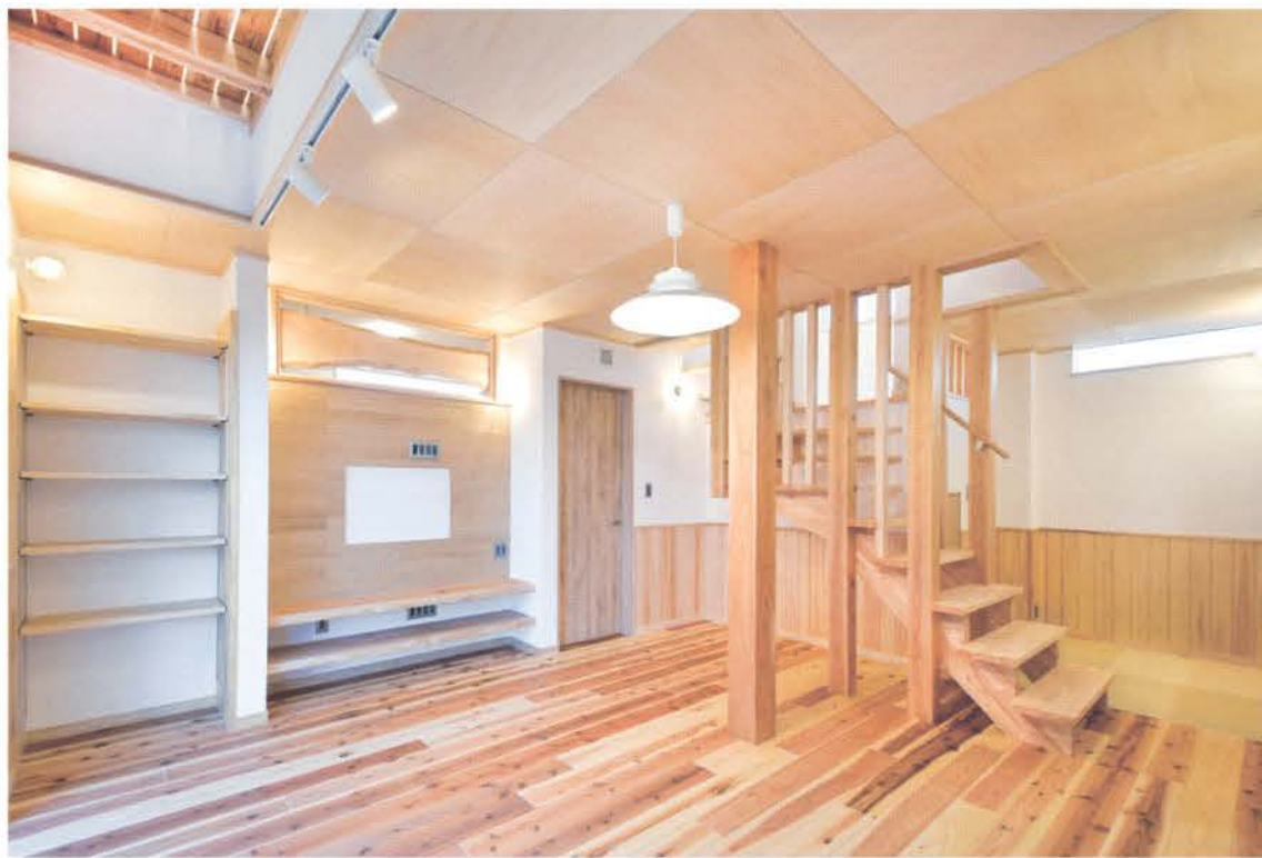
断熱等級6、耐震等級3、ソーラーカーポートを併設した長期優良住宅。無垢の木をふんだんに用いたリビング空間は、床と腰壁に杉、天井にはシナベニヤを張った。階段やテレビボード、収納棚など造作が豊富。コーナーには畳フロアも採用した。
